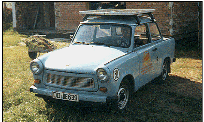
Trabi aus Dresden mit 200 Watt Solardach
